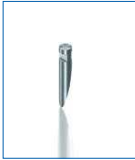
Końcówka 20,5 mm Nr kat.: 101-010-205 węglkowa, \varnothing 3,5 mm / R: 25 \mu m / A: 12° zgodna z Mahr (6850289)
